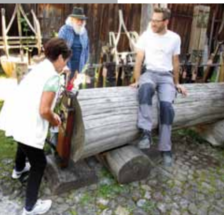
Mann und Baumstamm lassen sich mit einer Stockwinde mühelos heben
