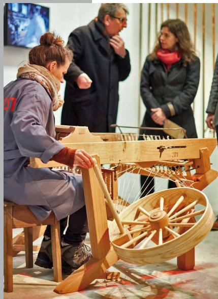
Spinnen wie vor 250 Jahren auf der nachgebauten Spinning-Jenny
