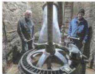
Eine Girard-Turbine hat bei 8,5 m Fallhöhe eine Leistung von 10 kW/13 PS.
