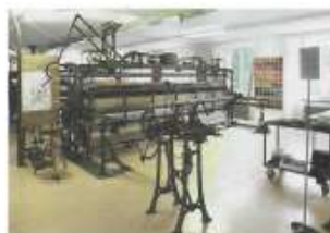
Die Handstickmaschine ermöglicht das parallele Bearbeiten von bis zu 80 verschiedenen Stoffbahnen.
